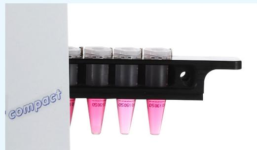
In der Probenkassette lassen sich bis zu 6 Proben in einem Arbeitsschritt messen – ideal für kleinere Serien.
