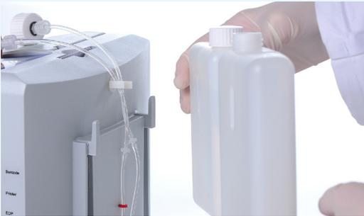
Spüllösung und Abfallbehälter werden in einer Einheit (Containerkit) angeschlossen und entsorgt. Somit ist die Gefahr von Kontaminationen minimal.
